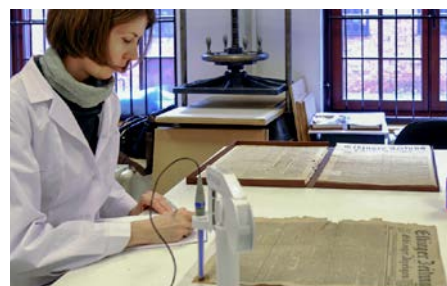
Joanna Sroka bei der Messung des pH-Werts bei Periodika mit saurehaltigem Papier
