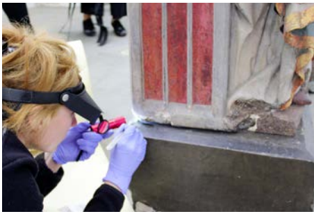
Steinprobenentnahme zur petrographischen Untersuchung von der Pietà aus der Danziger Marienkirche
