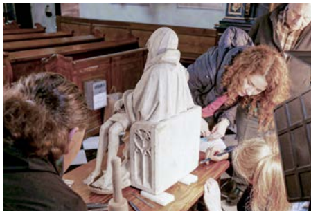
Steinprobenentnahme zur petrographischen Untersuchung von der Krakauer Pietà
